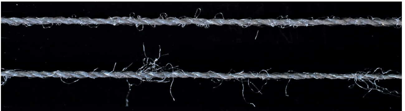
Oben Mara 120 MCT, unten ein Umspinnzwirn gleicher Stärke.
